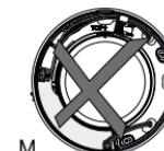
Non effettuare contemporaneamente la connessione a 100–240 V CA e 12 V CC (Figura M).
