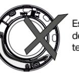
Este interzisă trecerea cablurilor de 100–240 V peste componente electronice (figura N).
