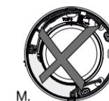
Conexiunile de 100–240 V.c.a. și 12 V.c.c. nu trebuie să fie simultane (figura M).
