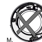
Der Anschluss von 100–240 V AC und 12 V DC darf nicht gleichzeitig erfolgen (Abbildung M).
