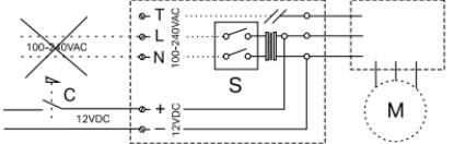
**Opgelet!** Gebruik voor 12 VDC altijd schakelaars bedoeld voor gelijkstroom, C.
