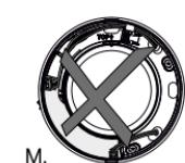
การเชื่อมต่อ 100–240 V AC และ 12 V DC จะต้องไม่ทำร้อนกัน (ภาพ M)
