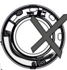
Er mogen geen 100 - 240 V-kabels over de elektronische componenten worden geleid (afbeelding N).
