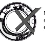
Nessun cavo da 100–240 V può essere posato sul componente elettronico (Figura N).
