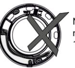
Na elektronické části spotřebiče nesmí ležet žádné kabely 100–240 V (Obrázek N).
